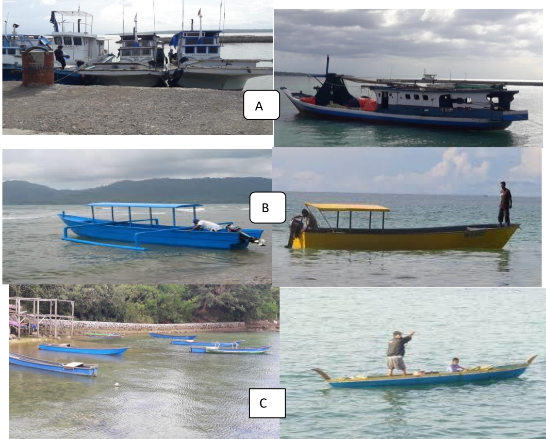
Gambar 8. Armada penangkapan ikan: a. kapal bermotor \geq 10 GT; b. perahu bermotor \leq 5 GT; c. perahu tanpa motor
