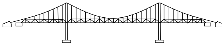
Gambar 2. Jembatan gantung dengan pengaku truss
